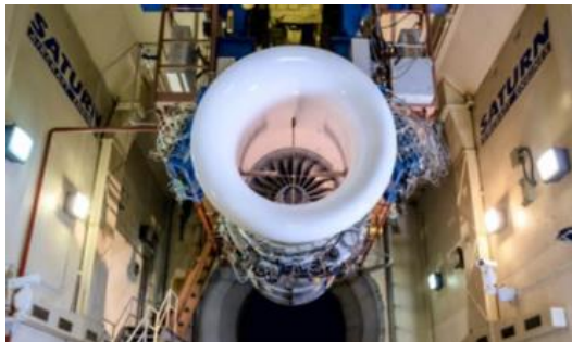
Рис. 3 Испытание опытных двигателей ПД-8: а) на стенде ПАО «ОДК-Сатурн»; б) в составе летающей лаборатории Ил76-ЛЛ
