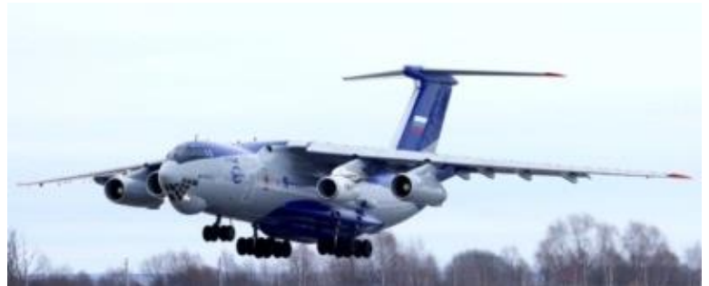
Рис. 3 Испытание опытных двигателей ПД-8: а) на стенде ПАО «ОДК-Сатурн»; б) в составе летающей лаборатории Ил76-ЛЛ
