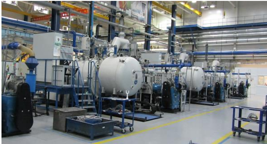
Рис. 2 Цех №41 ПАО «ОДК-Сатурн», новый участок литья лопаток с направленной и монокристаллической структурами
