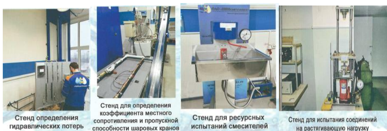
Рис. 2 Испытательные стенды для проведения испытаний санитарно-технического оборудования на соответствие действующими ГОСТами
