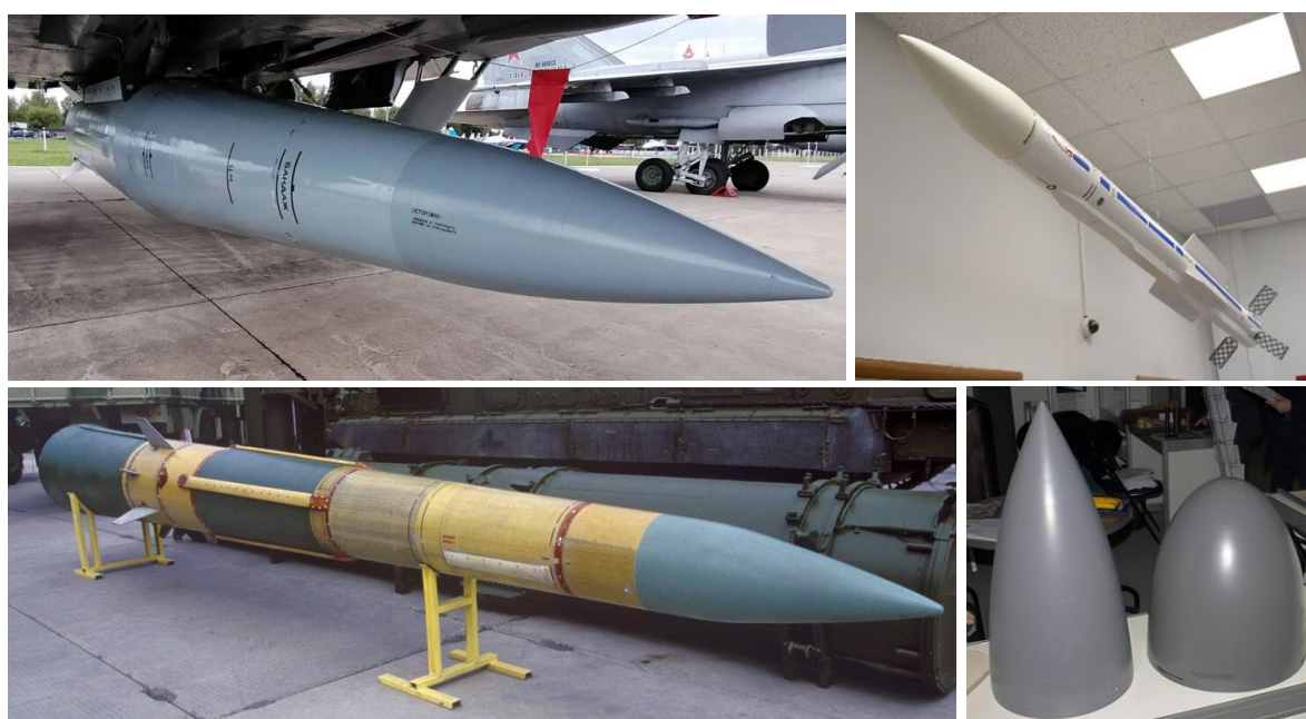
Рис.1 – Внешний вид РПО УР производства АО «ОНПП «Технология» им. А.Г. Ромашина» (г. Обнинск, Калужская область)
